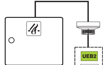
mit Brandmeldeanlage und automatischem Melder
